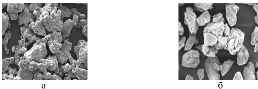
Рис. 2. Морфология частиц порошков железа (а) и бикарбоната аммония (б)
